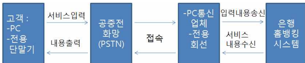
<그림 3> 홈뱅크시스템 구성도
